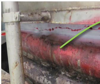
Risse in der Gefäßwand (sichtbare rote Linie)
