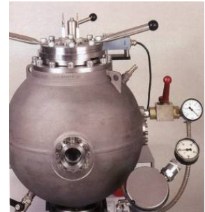
Figure 3 : détermination des paramètres d'explosivité ( K_{ST} et P_{max} ) dans la sphère de 20 L
