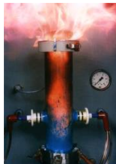
Figure 2 : détermination de l'énergie minimale d'inflammation de la poussière
